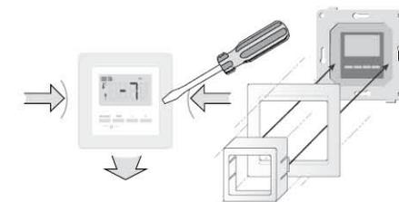
2. Подключите провода питания, нагревательную секцию или нагревательный прибор (нагрузку) и выносной датчик температуры, соблюдая порядок подключения клемм, приведенный на рисунке. Присоединяемые провода должны иметь сечение 0.75 – 2.5 мм<sup>2</sup> в зависимости от мощности нагревательных приборов. **Нагрузка мощностью более 3500 Вт подключается через магнитный пускатель.**
