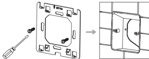
д) После подключения терморегулятора к проводам, закрепите прибор на крепежной пластине и наденьте лицевую панель и рамку.
