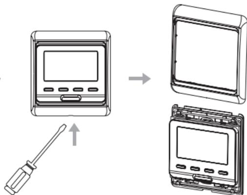
б) С помощью отвертки снимите заднюю крепежную пластину, как показано на рисунке.
